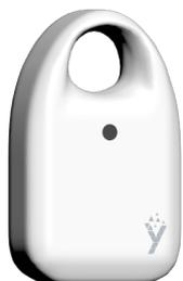
O yCon CN0010 é um beacon para uso pessoal, com longa duração de bateria, tipicamente usado pendurado junto com o crachá da empresa.
